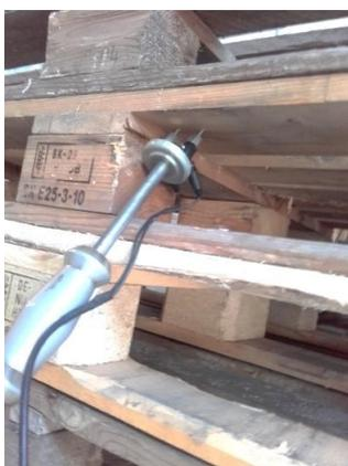
Photo 3 : Mesure d'une planche P1 ou P5 par dessous
