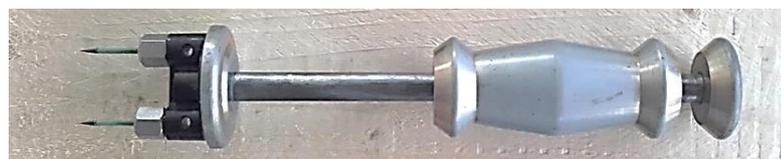
Photo 2 : porte électrodes à marteau
